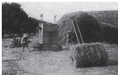
doc.5 Les premières presses à fourrages: le prototype des roundballers.
