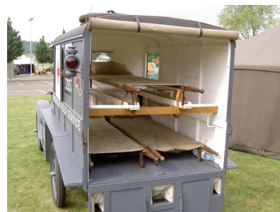
doc.16 Photo de l'arrière d'une ambulance Ford T de l'AFS où étaient installés les blessés.
