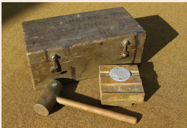
doc.39 Boîte de lettres à frapper utilisées pour nommer les plaques et les couverts, dimensions: 20 x 10 x 8 cm.
