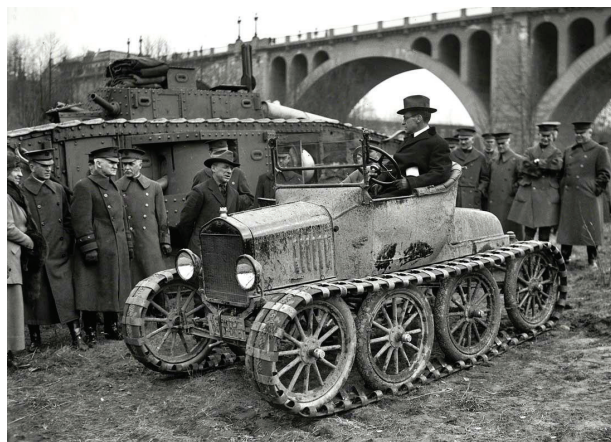
doc.17 Après guerre, un prototype de Ford T à chenilles est présenté en 1920 devant des officiels.
