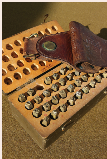
doc.46 Boîte à frapper les cuirs, dimensions : 20,5 x 10,5 x 8,5 cm, ouverte.
