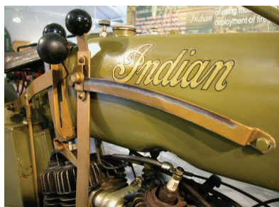
doc.11 Détails des commandes d'une Indian Power Plus restaurée de 1919.
